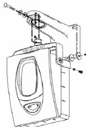
Detektor kan justeras upp till 10° vertikalt och horisontalt för att säkra att ljusstrålen träffar reflektorn optimalt. Vid behov av ytterligare justering utföres detta med hjälp av monteringsbrakett BEAM-MMK som möjliggör 28° vertikal och 360° horisontal justering vid montering i tak och upp till 23° vertikalt och 90° horisontal justering vid montering på vägg.
