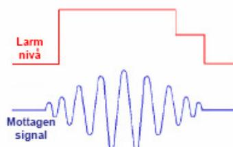
Detektor kompenserar också automatisk för avdrift förorsakat av nedsmutsning eller andra faktorer som reducerar signalen över längre tid, och därmed upprätt hålls optimal detektion genom att korrigera larmnivåerna.
