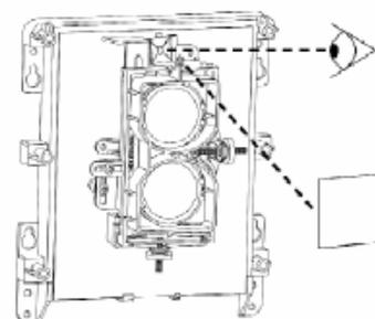
Testning av linjedetektorer som er monterade högt uppe är vanligtvis svårt. 6500RS har en unik funktion som gör att en komplett test av optik och elektronik kan styras från en aktivator som monteras lättåtkomligt. Därmed undgår man behovet för stege eller lift för att få tillgång till enheten vid periodisk testning. Ett optiskt filter blir automatisk aktiverat framför linsen. Detta skymmer gradvis den returnerade ljusstrålen och gör att detektor går i larm.
