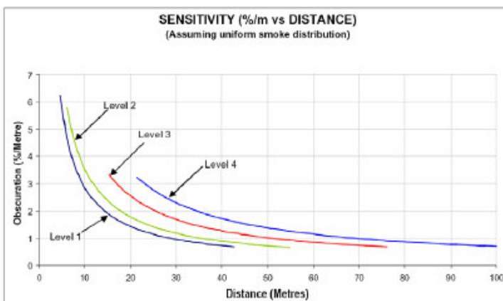
Utöver de fyra fasta känslighetsnivåerna för larm, är det också två variabla nivåer som automatisk kompenserar för ändringar i miljön. Dessa ändringarna, som detektor justerar för, kan annars leda till oönskade larm. Detektor använder avancerade algoritmer för att analysera mottagna signaler och därmed justera känslighet och larmnivåer automatiskt. Detta ger optimal detektion i ostabila miljöer.
